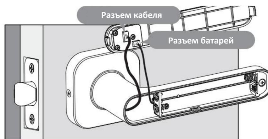
9. Установите 4 батарейки типа AAA и крышку батарейного отсека.
