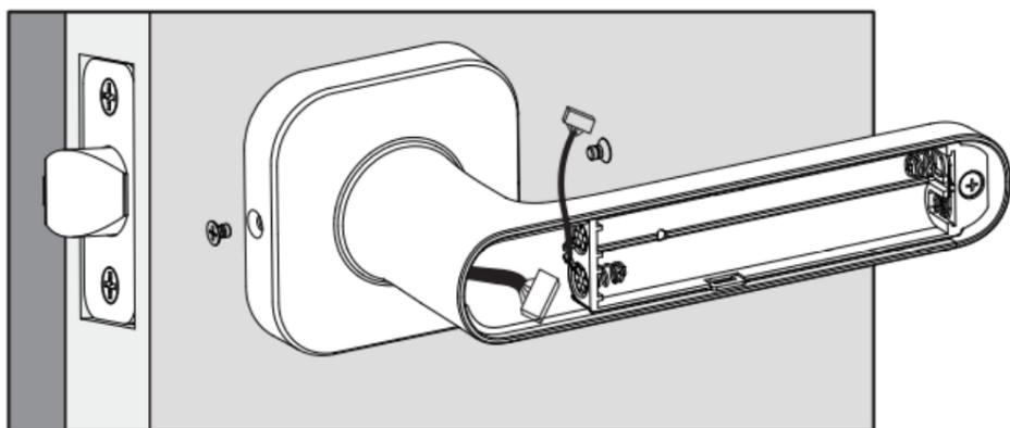
8. Вставьте кабельный разъем и кабель батарей в разъем крышки батарейного отсека
