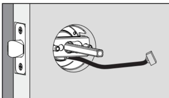
Стержень должен плавно скользить через отверстие в защелке. Если нет, проверьте размеры двери.
