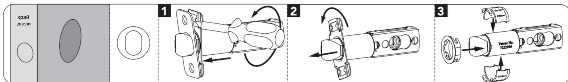
С. Отрегулируйте углубление защелки помощью болта
