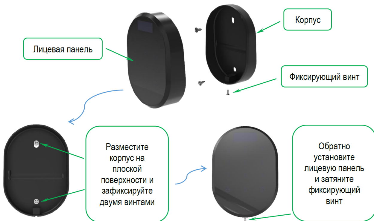
Рисунок 3 – Порядок установки кодовой панели
